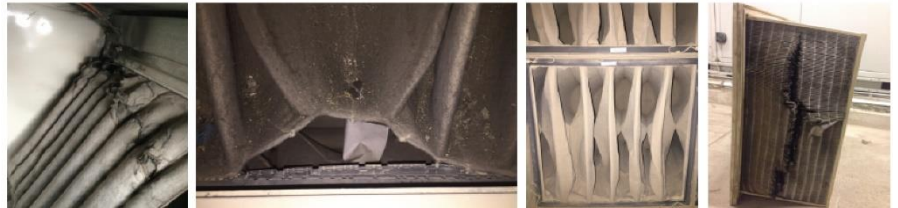
Figura 2: Fallos habituales de los filtros de las unidades de tratamiento de aire (rotura, desintegración, deformación, fractura).
